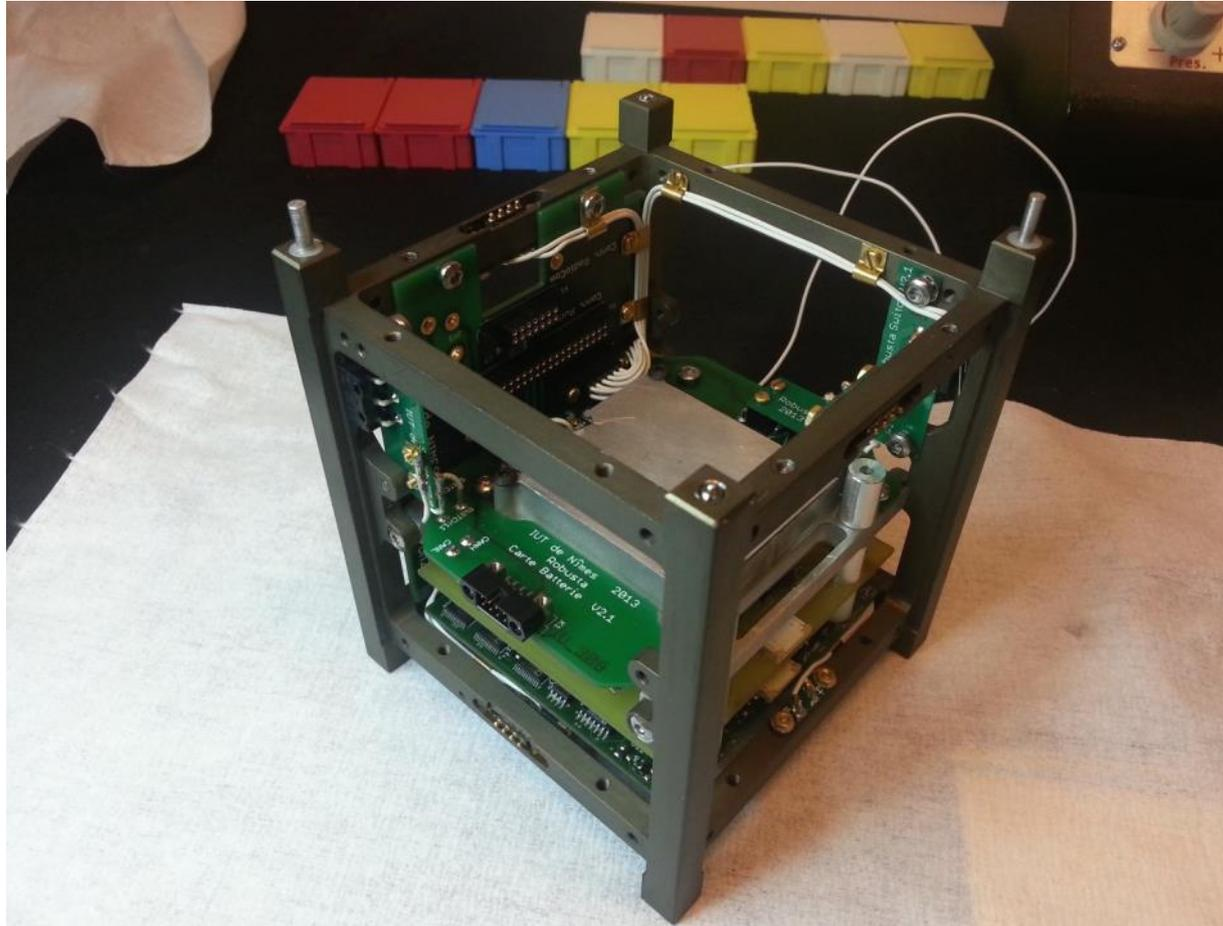
Robusta-1B dont le fond de panier, faisceau et batterie sont assemblés. Prêt pour livraison au CSU
