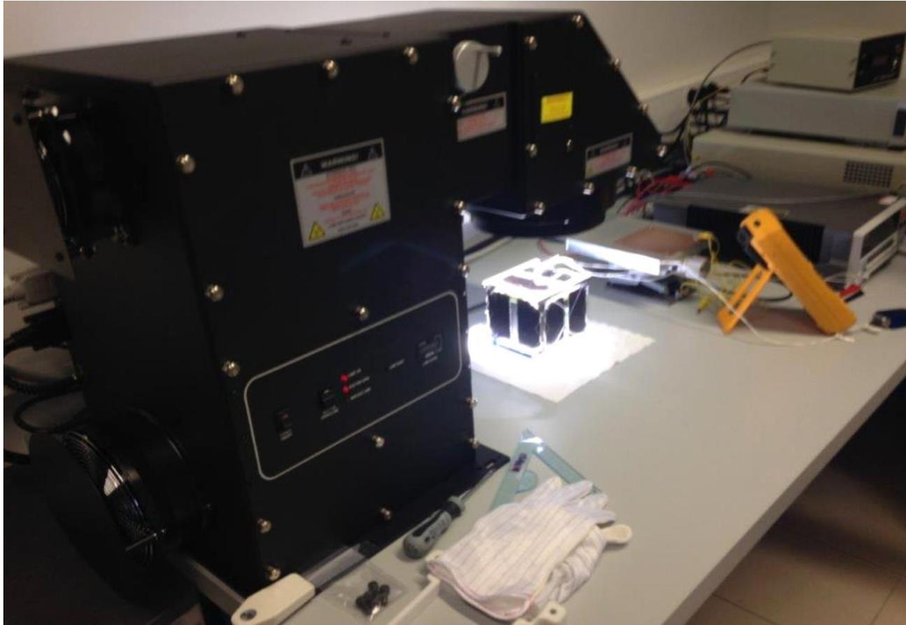
Test du système de production d'énergie au moyen d'un soleil artificiel à l'IES
