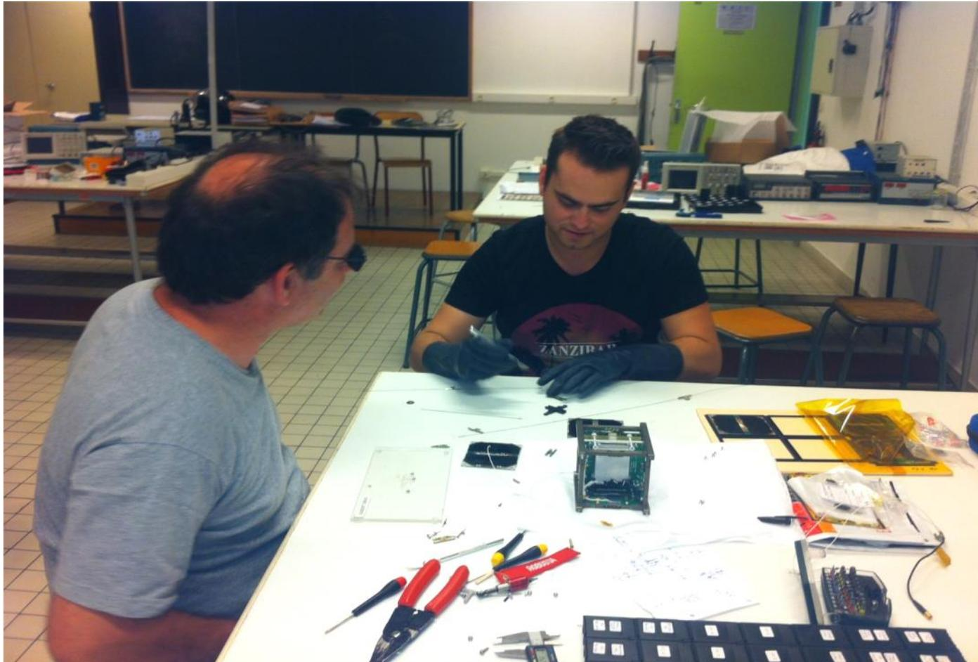
Assemblage du fond de panier et de la platine batterie
